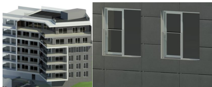
Figura 6.2 – Fachada posterior com placas de fibrocimento 180x100cm 2 .
